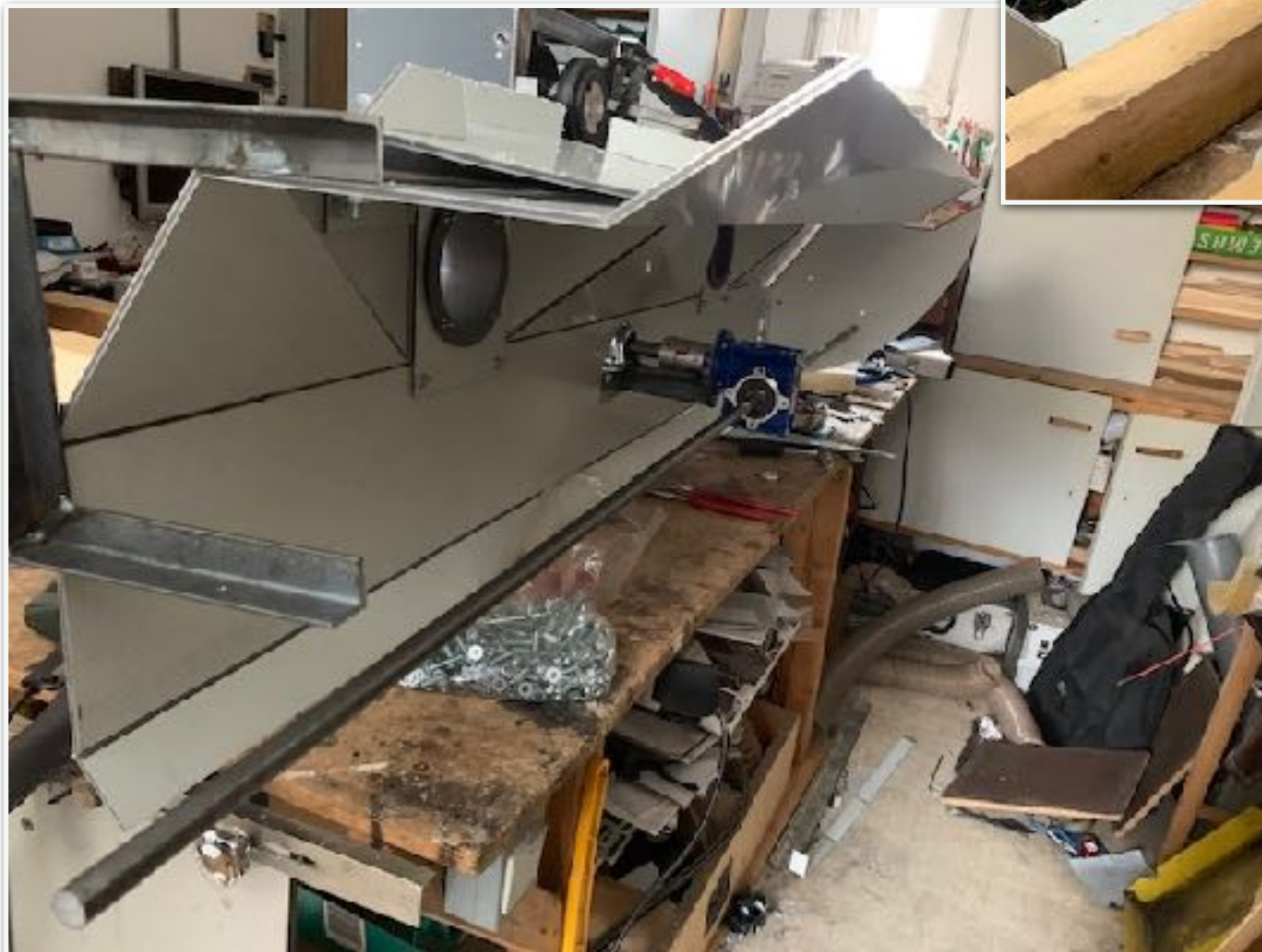
Konstruktionsversuch einer Bürst-Saugmaschine zur Beerntung spezifischer Wildsamens
